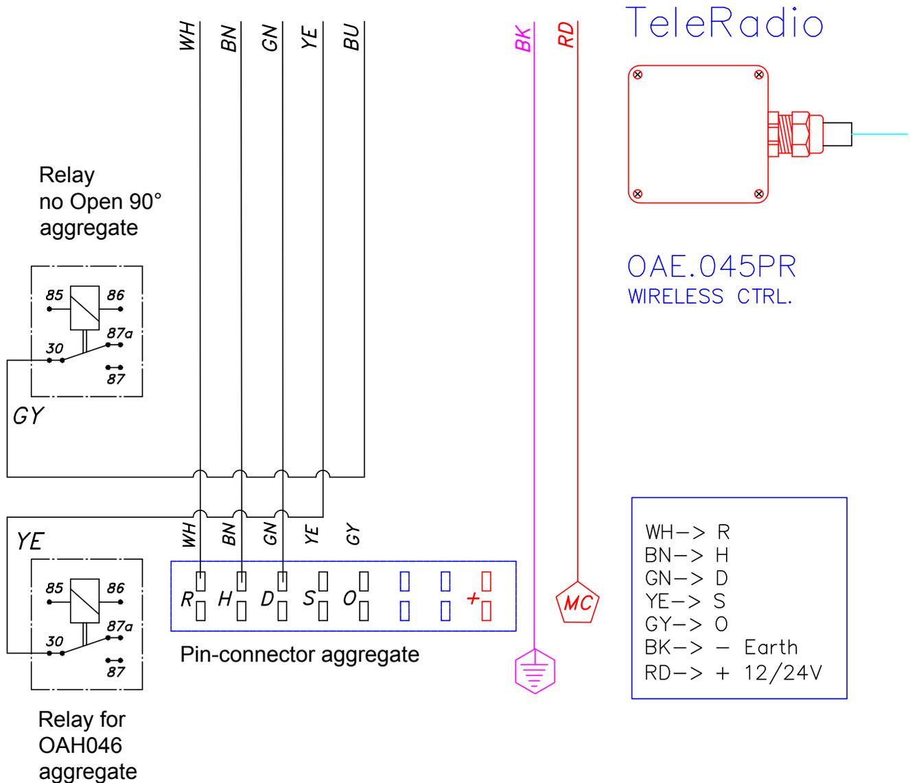
**Für OAH046 / OAH029 Funkbedienung direkt im Aggregat an der Steckliste anschliessen.**
